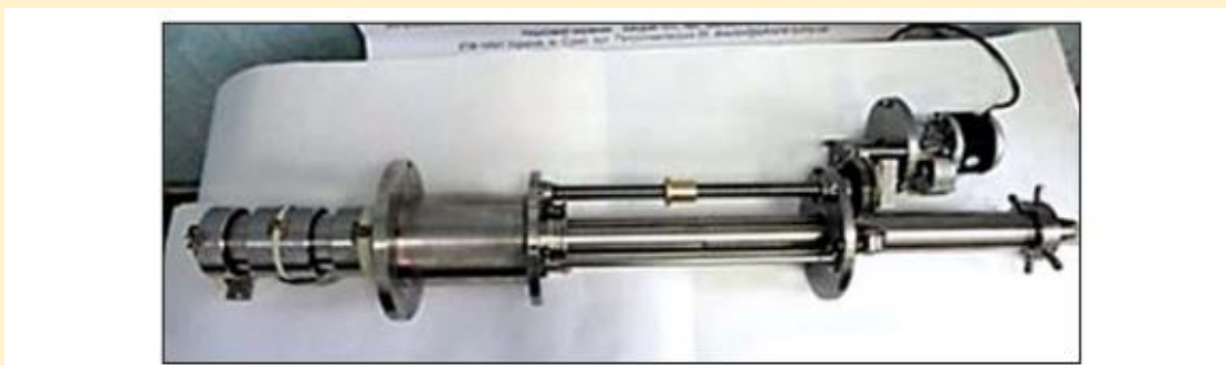
Рис. 4. Магнетронний випарувач для нанесення покриття в каналі гарматного ствола
