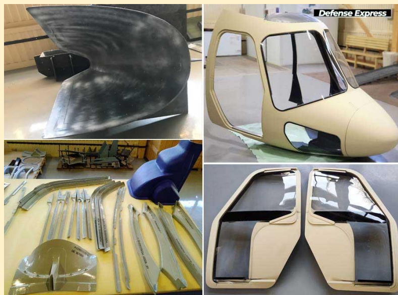
Композитні частини гелікоптера Мі-2МСБ від «Співдружність Авіа Строй»
